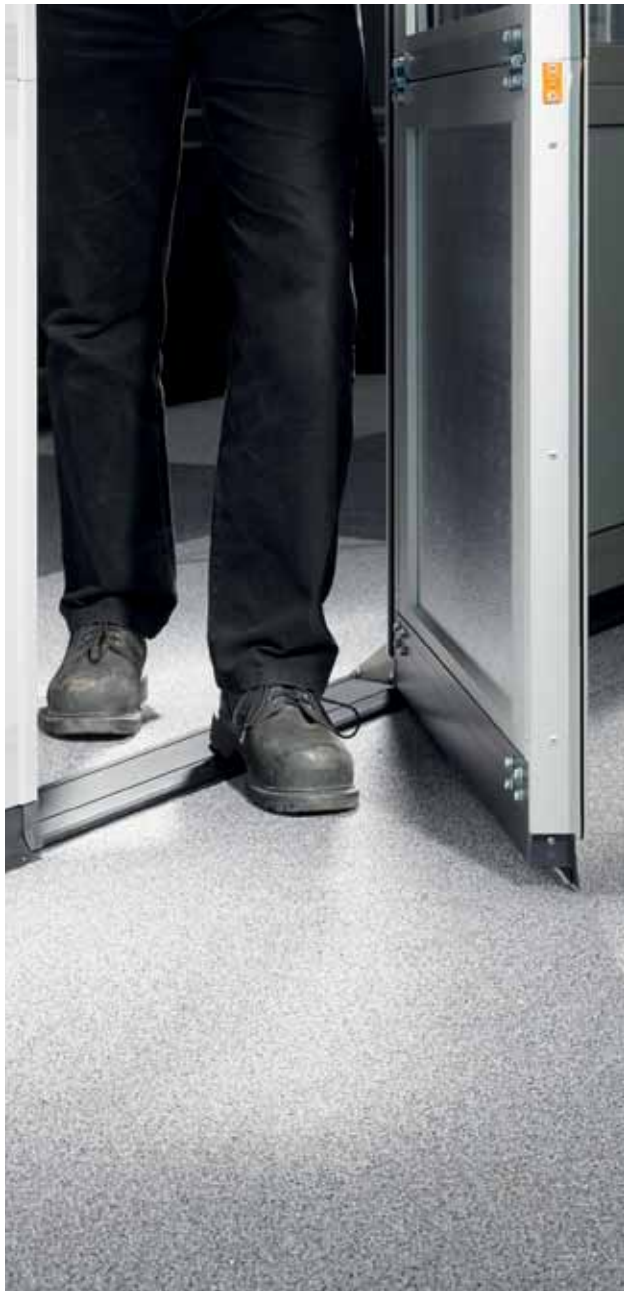
Optioneel is ook een ingewerkte loopdeur verkrijgbaar met een tot 20 mm verlaagde drempel. Deze nieuwe, bijna drempelvrije voetgangersdeuren bieden een veilige en onbelemmerde toegang voor voetgangers. De drempel, die aan beide zijden is afgeschuind, biedt ook toegang voor apparatuur op wielen.
